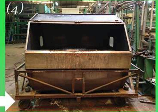
(3) Caustification réductible à chaud : passage du tissu dans une solution de soude puis enroulement à chaud par projection d'eau sous pression (photo 3). Une phase de maturation d'une heure se déroule dans un caisson afin d'éliminer les impuretés comme l'amidon (photo 4).
