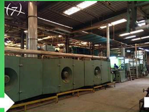
(6) Ramage du tissu (étirement) afin de le faire sécher. Il est ensuite mis à la laize (photos 6 et 7) c'est-à-dire mis à bonne dimension, à une largeur de 115-116 cm. Parfois le coton est traité avec du jaune pour permettre la pose de colorants azoïques (photo 8).
