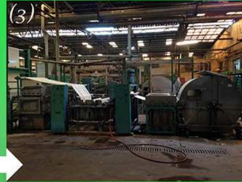
(3) Caustification réductible à chaud : passage du tissu dans une solution de soude puis enroulement à chaud par projection d'eau sous pression (photo 3). Une phase de maturation d'une heure se déroule dans un caisson afin d'éliminer les impuretés comme l'amidon (photo 4).
