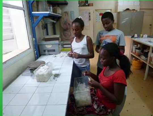
L'égrenage du coton (=séparer les graines des fibres)
