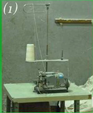
(1) Assemblage du coton non traité en bandes de 900 à 6000 mètres cousues les unes aux autres (photo 1). Les défauts des bandes sont éliminés par la tondeuse (photo 2).
