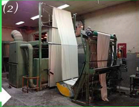
(1) Assemblage du coton non traité en bandes de 900 à 6000 mètres cousues les unes aux autres (photo 1). Les défauts des bandes sont éliminés par la tondeuse (photo 2).
