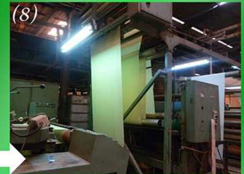
(6) Ramage du tissu (étirement) afin de le faire sécher. Il est ensuite mis à la laize (photos 6 et 7) c'est-à-dire mis à bonne dimension, à une largeur de 115-116 cm. Parfois le coton est traité avec du jaune pour permettre la pose de colorants azoïques (photo 8).
