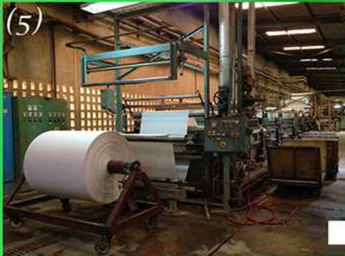
(5) Lavage du coton dans de l'eau, du savon et des substances tensio-actives. Le tissu devient hydrophile.
