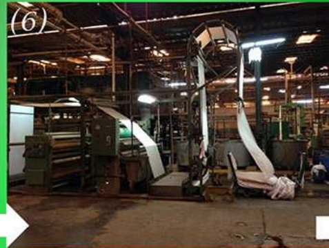
(6) Ramage du tissu (étirement) afin de le faire sécher. Il est ensuite mis à la laize (photos 6 et 7) c'est-à-dire mis à bonne dimension, à une largeur de 115-116 cm. Parfois le coton est traité avec du jaune pour permettre la pose de colorants azoïques (photo 8).
