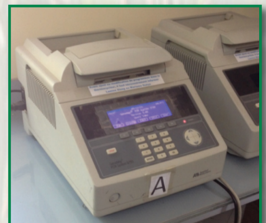
Thermocycleur permettant d'amplifier des fragments d'ADN.
